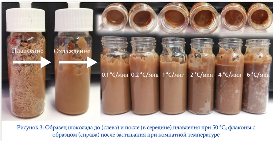
Рисунок 3: Образец шоколада до (слева) и после (в середине) плавления при 50 °C; флаконы с образцом (справа) после застывания при комнатной температуре
